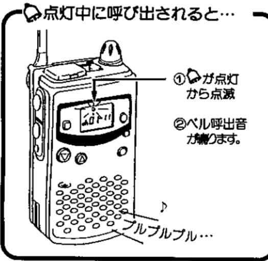
● ベル呼出音が必要ない時は、ピープ音をOFF (☞P46)にしておくと、ベル音は鳴らず ● が点滅します。
