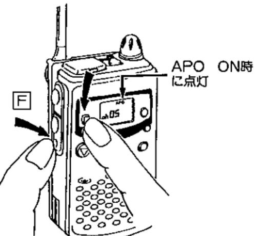
APO点灯中は30分間呼出しを受けず、キー操作がなければ自動的に電源が切れます。
