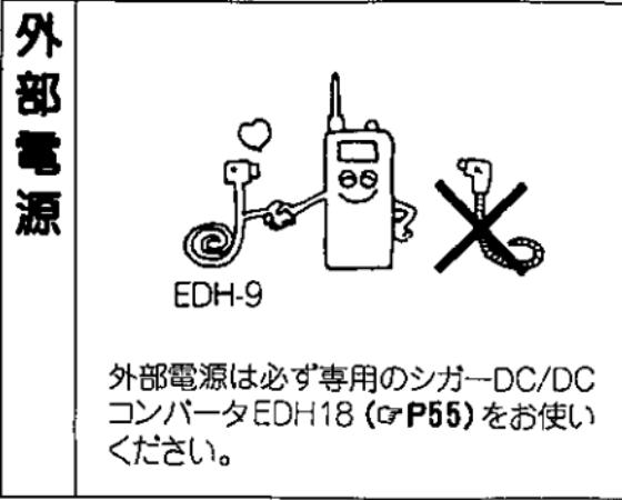
外部電源は必ず専用のシガードC/DCコンバータEDH18 (☞P55)をお使いください。
