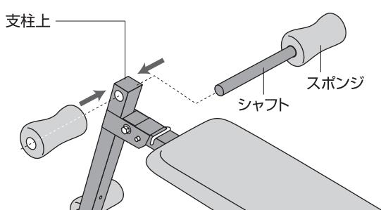
支柱上端の穴にシャフト(仮付けされているスponジの片方を外し)を挿入し、外したスponジを装着し直します。
