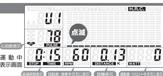
ハートレートコントロール機能では、年齢情報から計算した心拍数に近づくようにペダル負荷を自動変化させますが、急激な加速などで設定した心拍数を超えると、アラームが鳴り出します。ストップはしませんが、設定した心拍数以下になるまで鳴り続けます。
