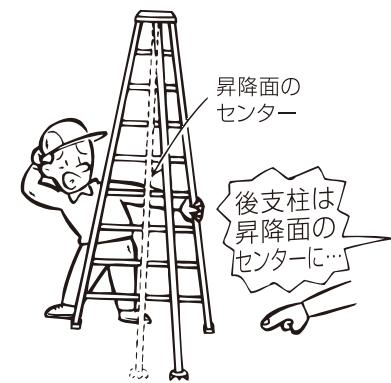
**△警告** 前支柱と後支柱の使用角度は、約75度にして設置してください。
