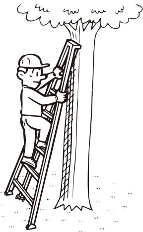
**△警告** 可動式の滑り止め(滑り止めユニット)は正しく設置してください。
