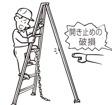
**△警告** 後支柱の長さが調整できるタイプは、調整金具が確実にロックされていることを確認してください。
