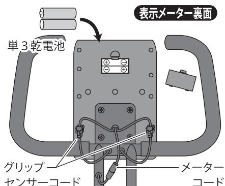
※ 組立完了後、表示メーターが作動しない場合は、組立手順6のコードの接続、組立手順7の乾電池の極性方向(+-)をご確認ください。
