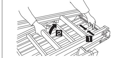
開閉解除レバーから手を離し、脚を引き上げる。
