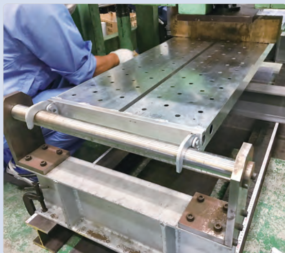
床付き布わく中央集中荷重試験
