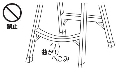
⑤各部の接合部に割れやいちじるしい腐食がありませんか。また、取り付け部品の破損・脱落・変形・摩耗・いちじるしい腐食がありませんか。ある場合は、絶対に使わないで廃棄してください。
