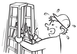
⚠ 警告 脚立を完全に開き、開き止め金具を確実にロックしてください。
