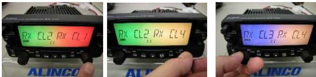
③ 右側ダイヤルを押すと同じくメニュー1 2状態になる。左側ダイヤルでTX CL 5 パープル、右側ダイヤルでTX CL 6 ライトブルーを選ぶ。マイクのP T Tを押し、設定を確定して、運用状態に戻る。
