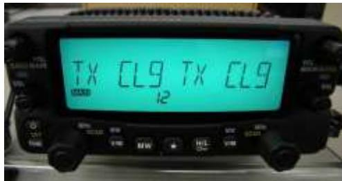
マイクの PTT を押して設定を確定して、運用状態に戻る。待ち受け状態なら VFO モードは左右ともオレンジ色になっている。V/M キーで VFO モードとメモリーモードを切り替え、好みの状態になったことを確認する。
