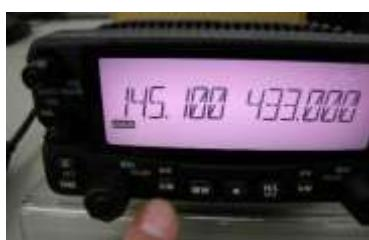
⑩ 右のVFOモードでダイヤルを回して433.200を表示させる。
