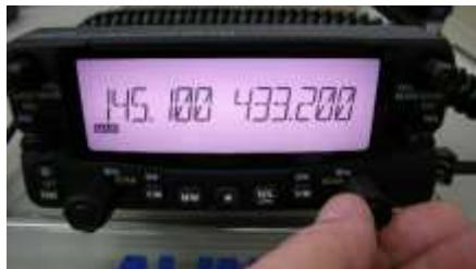
⑪ FUNCキーを押して、メモリー番号が表示されたら433.200が出ている側のダイヤルを回して001を選び、同じ側のV/Mキーを押す。ビープ音が鳴って、001が消える。
