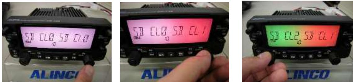
② 右側ダイヤルを押すとP. 4 2のメニュー1 1状態になる。左側ダイヤルでRX CL L 3 ブルー、右側ダイヤルでRX CL 4 イエローを選ぶ。
