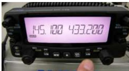
この状態でメモリー運用したい側のV/Mキーを押すと、メモリー番号が表示されるので、000と001をダイヤルで切り替えて色が指定したように変化することを確認する。
