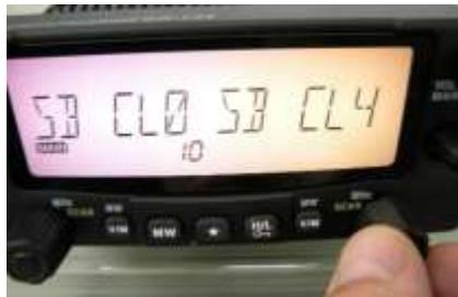
⑭ 右側ダイヤルを押してメニュー番号 1 1 で、0 0 0 を表示させた側のダイヤルを回して RX CL 5 パープルを選ぶ。
