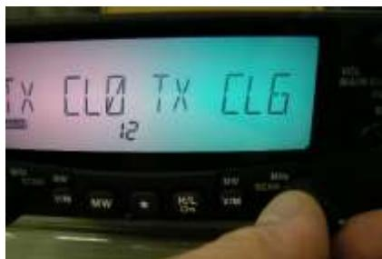
マイクの PTT を押して設定を確定して、運用状態に戻る。0 0 1 表示側（メモリーモード側）はイエローになっている。
