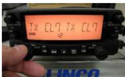
マイクの PTT を押して設定を確定して、運用状態に戻る。表示は赤になっている。
