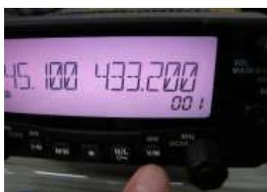
⑬ FUNCキーを長押ししてセットモードに入り、ダイヤルを何回か押してメニュー一番号10を表示させ、001が出ていたのと同じ側のダイヤルを回してSB CL4イエローを選ぶ。
