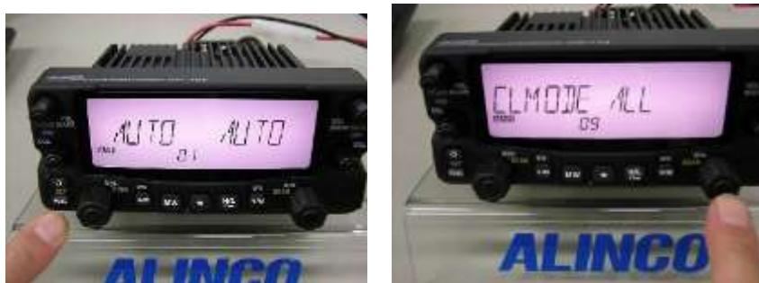
① 右側ダイヤルを押すとP. 41のメニュー10状態になる。右側ダイヤルでSB CL1レッド、左側ダイヤルでSB CL2グリーンを選ぶ。
