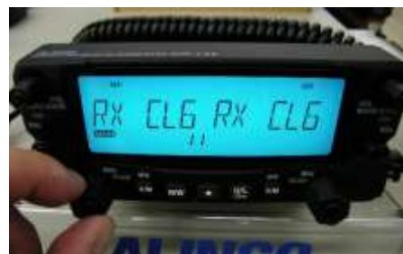
マイクのP T Tを押し、設定を確定してV F Oモードの運用状態に戻る。
