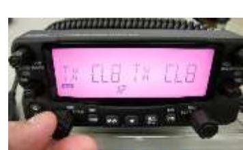
マイクのP T Tを押して設定を確定して、V F Oモードの運用状態に戻る。
