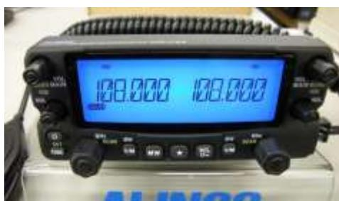
⑧ ボリュームツマミを長押しして、430MHz帯の2波同時受信状態にする。
