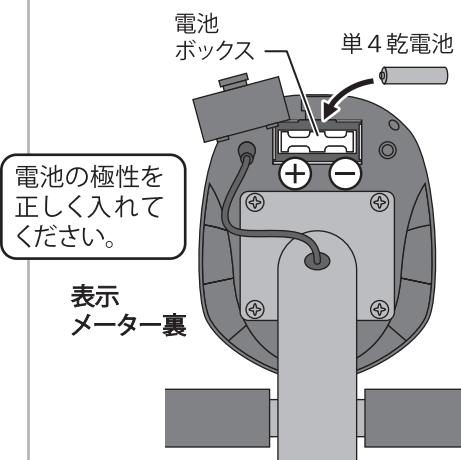
※ 組立完了後、表示メーターが作動しない場合は、組立手順4・7のコードの接続と組立手順8の乾電池の接続をもう一度ご確認ください。
