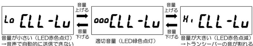
接続機器から送信する音声を鳴らしてください。音量によって表示とLEDが変化します。左上の表示が「000」になりLEDが緑色に点灯するように、接続機器側の音量を調整してください。音量表示の変化には時間が掛かるため、音源を何度か繰り返し再生してLEDが赤色点灯や赤色点滅にならないことをご確認ください。
